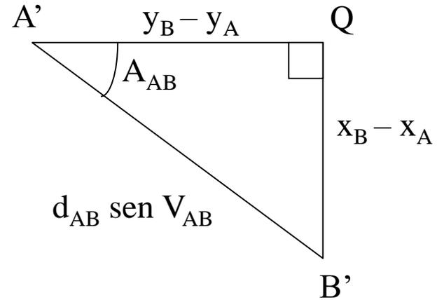
$$x_B - x_A = d_{AB} \text{ sen } V_{AB} \text{ sen } A_{AB}$$
