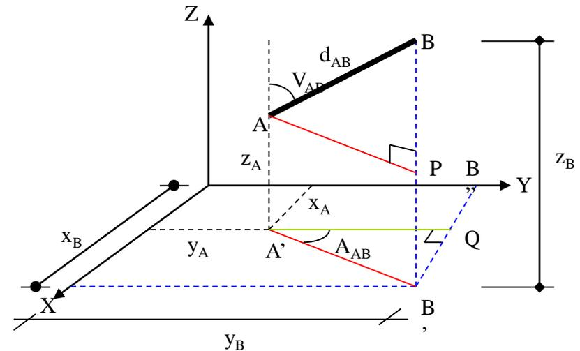
$$x_B = x_A + d_{AB} \text{ sen } V_{AB} \text{ sen } A_{AB}$$
