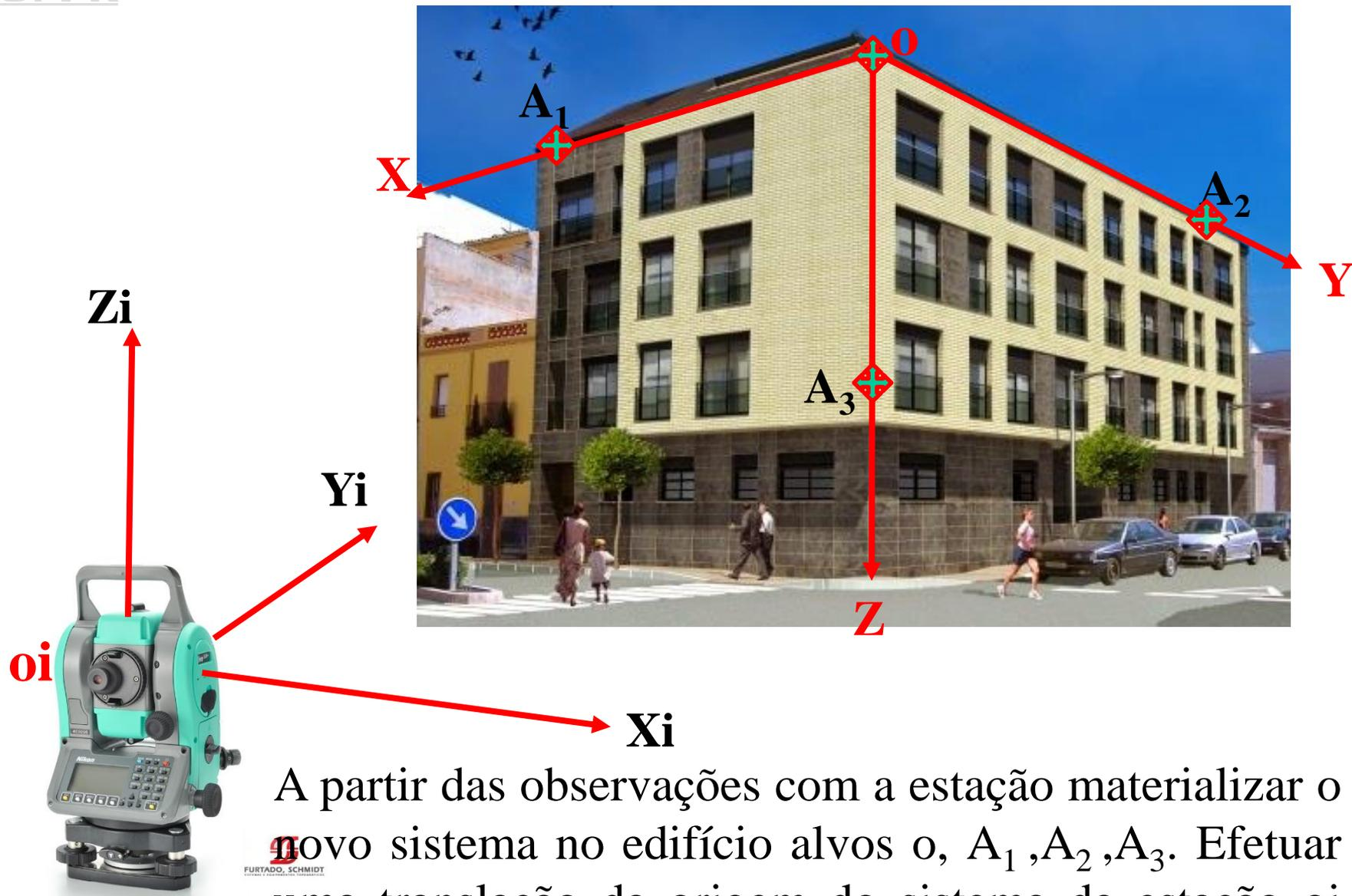
A partir das observações com a estação materializar o novo sistema no edifício alvos  $O, A_1, A_2, A_3$ . Efetuar uma translação da origem do sistema da estação  $oi$  para o ponto  $O (X_i, Y_i, Z_i)$ .
